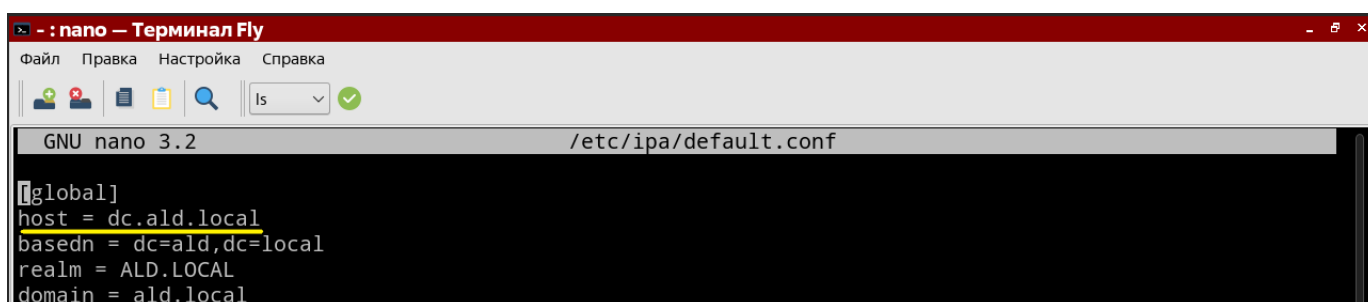
Рисунок 5.45 – Параметр «host» конфигурационного файла default.conf
