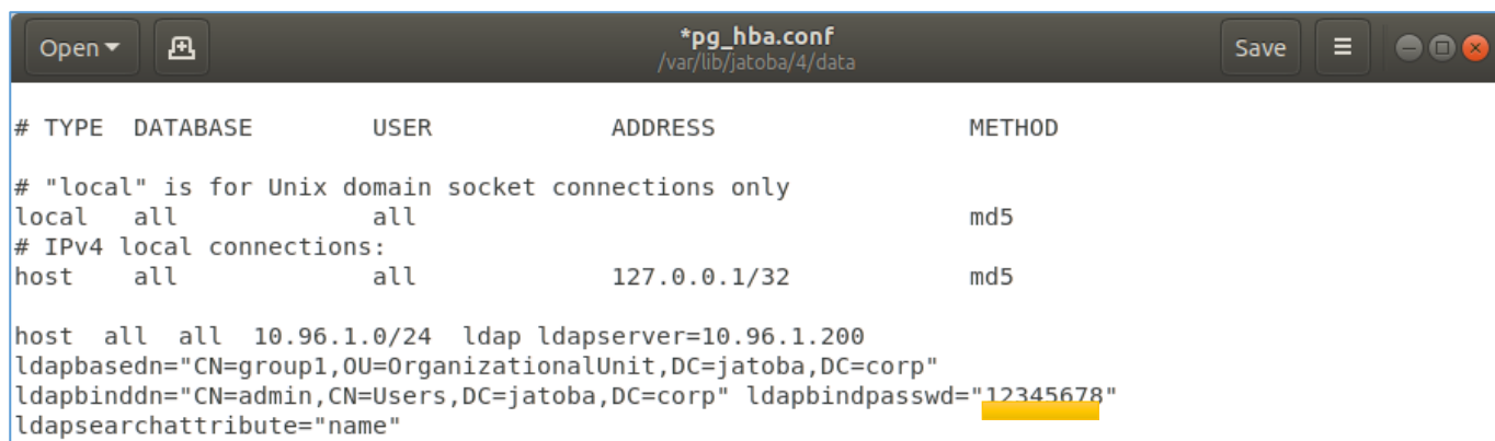
Рисунок 5.37 – Конфигурационный файл pg_hba.conf для аутентификации по атрибуту 'name'
